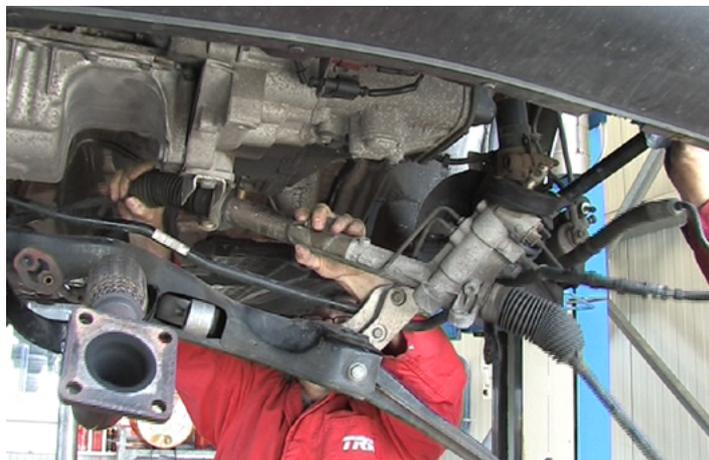
Un second mécanicien est requis pour l'étape de travail suivante. Retirez l'unité complète de la crémaillère de direction, les tuyaux et le groupe moteur-pompes.
