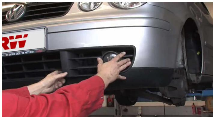
Pour garantir un accès aux connexions de la pompe, il est recommandé de démonter le feu antibrouillard. Retirez d'abord le revêtement et ensuite le feu complet.
