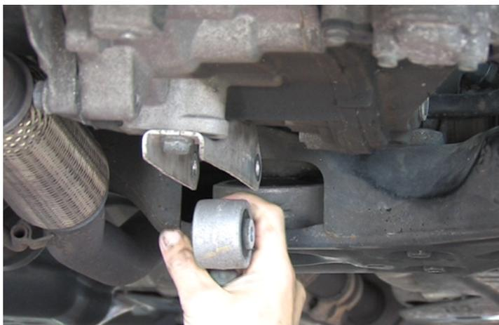
Retirez la vis de fixation du support de couple au niveau de la fixation sur le bloc moteur et tirez le support de couple vers le bas.
