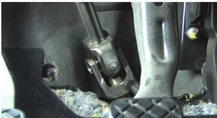
Retirez la vis de serrage sur le joint de cardan de la colonne de direction et sortez le joint à cardan de la crémaillère de direction.
