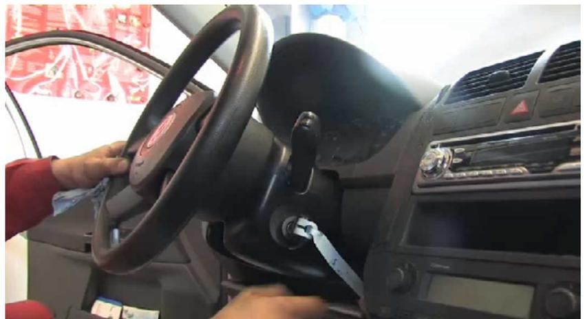
Avant le début des travaux, la batterie doit être déconnectée et le volant de direction doit être fixé en position centrale avec le blocage du volant. Cela évite une torsion et ainsi un endommagement du rouleau de contact de l'Airbag
