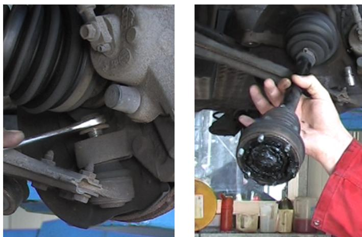
Démontez la rotule de suspension de gauche de la fusée d'essieu.
