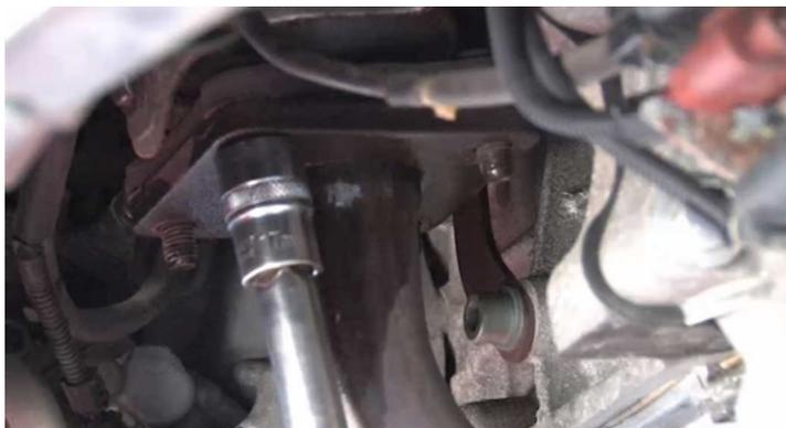
Retirez à l'étape suivante les vis de fixation du tuyau d'échappement avant du collecteur d'échappement. Retirez le tuyau d'échappement.
