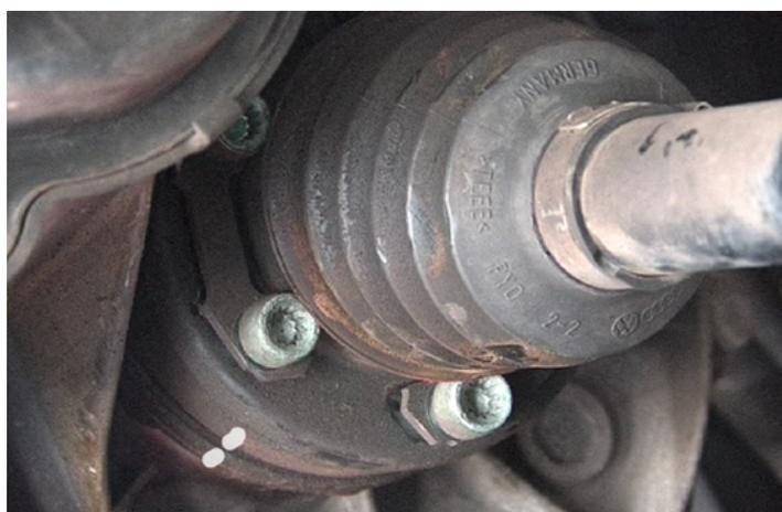
Démontez les vis de fixation de l'arbre de transmission de gauche sur la transmission.
