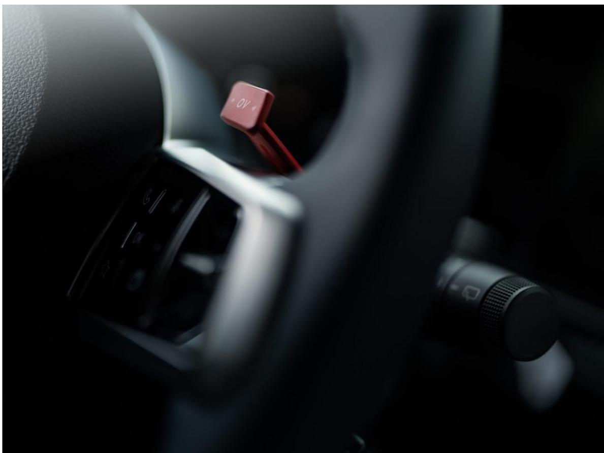
La puissance de régénération est réglable sur quatre niveaux depuis le volant avec un bouton physique marqué RCH (pour Recharge). La première position laisse la voiture en roue libre complète, le niveau 1 correspond à un frein moteur proche de celui que l'on trouve dans l'A110, et les niveaux 2 et 3 augmentent progressivement le niveau de freinage régénératif, permettant au conducteur de choisir le mode de régénération adapté à ses goûts, à son style de conduite ou aux conditions de roulage.
