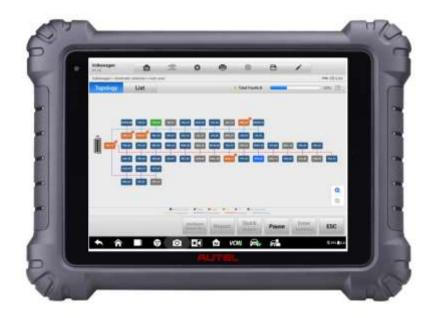
Désormais l'affichage topologique n'est plus l'apanage des concessions, MaxiSYS MS919 intègre nativement cette fonction, ce mode d'affichage présente un avantage certain grâce à une visualisation des calculateurs par une synoptique globale, cartographiant l'arbre CAN BUS. Cela va apporter en recherche de panne une lecture des systèmes et sous-système biens plus aisée et précise ainsi que les dépendances entre calculateur facilitant grandement la compréhension.
