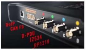
La nouvelle MaxiFlash VCMI ajoute une nouvelle dimension aux capacités de diagnostic déjà poussées d'Autel en combinant un dispositif de communication et de programmation VCI/J2534 amélioré intégrant un oscilloscope précis & réactif, un multimètre puissant et un testeur de ligne de bus CAN OBDII essentiel à un diagnostic intelligeant.
