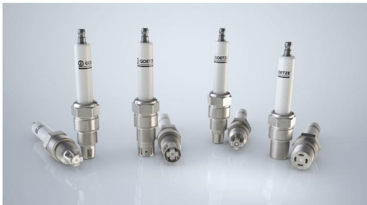
Le Business Group Powertrain de Tenneco lance sous la marque GOETZE® une nouvelle gamme de bougies d'allumage destinées aux moteurs à gaz industriels et adaptées aux applications de production d'énergie (gaz naturel, biogaz, gaz de décharge et gaz de mine). Les quatre nouvelles bougies d'allumage industrielles GOETZE sont dénommées G-6001, G-6002, G-6003 et G-6004 (de gauche à droite).
