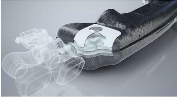
Les boucliers thermiques multicouches de Tenneco sont élaborés à partir d'un isolant pris en sandwich entre deux fines couches d'acier inoxydable, minimisant ainsi le profil, le poids et l'espace d'installation.
