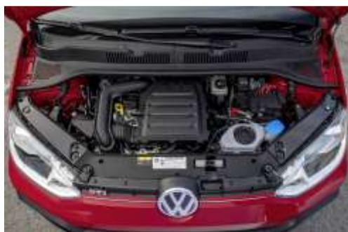
Le moteur Volkswagen est un moteur high-tech, léger et compact. Le moteur essence de 115 ch est le premier de sa catégorie à être associé à un convertisseur catalytique à quatre voies et installé sur la up!. Il est également équipé d'un filtre à particules essence. Le traitement des gaz d'échappement, combiné
