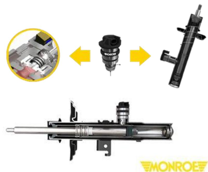
Le système de contrôle de la suspension intelligente RideSense™ de Monroe repose sur un calculateur qui traite les données à raison de 500 vérifications par seconde. L'ECU utilise une plage de valeurs pour déterminer le niveau d'amortissement idéal pour chaque amortisseur :
