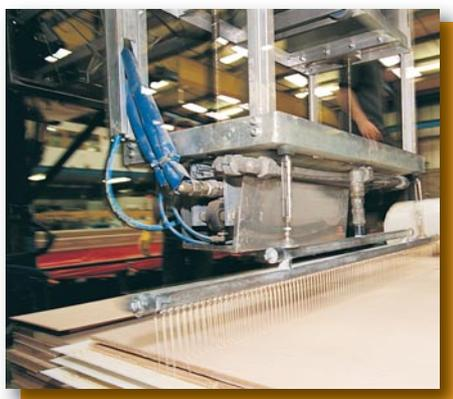
Sika Industry propose SikaForce®-7712 L35/L80, une colle tri composant destinée à la fabrication de panneaux sandwichs.
