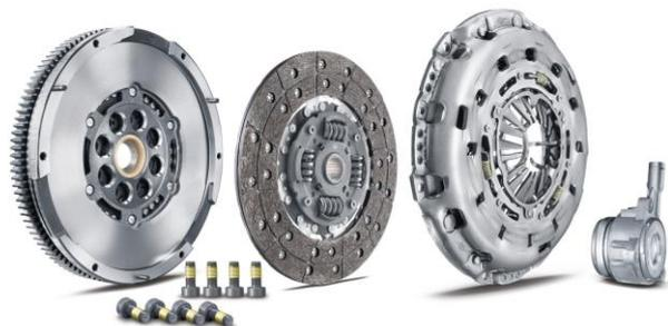
Schaeffler est le seul fournisseur à proposer le volant bimasse à technologie Impact Torque Limiter (flasque avec garniture de friction), notamment pour le Ford Transit et l'Iveco Daily, qui permet de réduire les pics de charge dans la chaîne cinématique.
