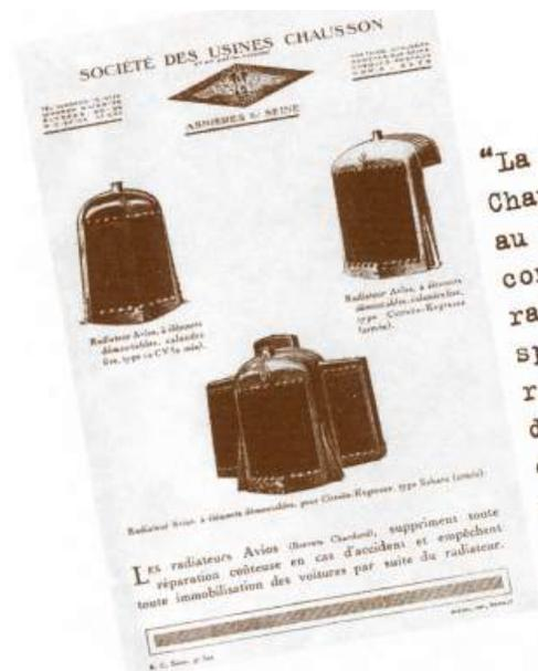
Les ailettes situées sur le dessus du radiateur permettent d'augmenter la surface d'échange et d'améliorer le refroidissement de la partie supérieure de ce dernier sur laquelle est fixée la boîte de condensation.
