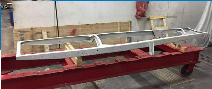
Le caisson arrière de Scarabée d'Or a été formé sous les mains des élèves de la section carrosserie du lycée : prise de mesures, dessins, coupe et assemblage au programme...
