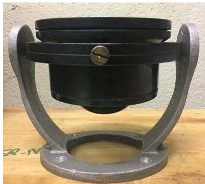
Le campus de Metz a également réalisé le porte compas du tableau de bord de Scarabée d'Or.
