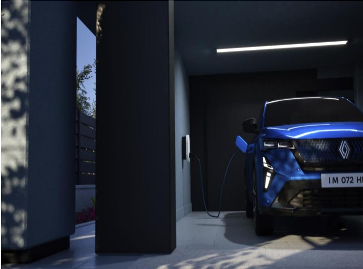
*À puissance maximale de charge acceptée soit 7,4 kW (32 A), la recharge complète de la batterie demande 2h 10 min pour 0 à 80 % et 2h 55 min pour 0 à 100 %*
