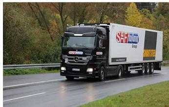
Pour les essais sur les transports sous température dirigée, SAF-HOLLAND utilise une semi-remorque frigorifique avec un groupe de réfrigération hybride et un système de freinage régénératif basé sur l'essieu électrique SAF TRAKr.
