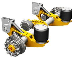
Particulièrement adapté aux véhicules frigorifiques, l'essieu à récupération d'énergie au freinage SAF TRAKr de SAF-HOLLAND réduit les émissions et la consommation de carburant de l'ensemble du convoi.
