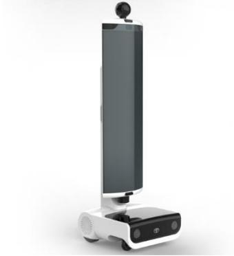
T-TR1 est un robot de mobilité virtuelle/téléprésence développé par le Toyota Research Institute aux États-Unis. Il est équipé d'un grand écran quasiment de taille humaine et coiffé d'une caméra.
