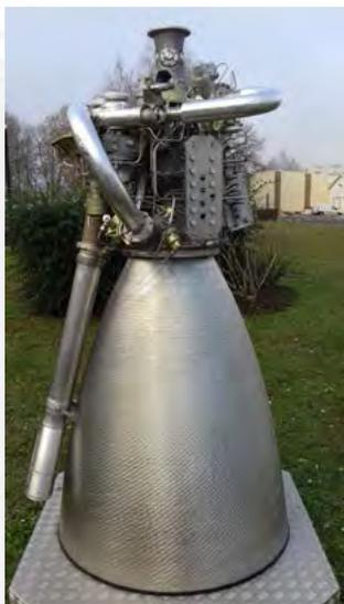
Propulseur du 3<sup>ème</sup> étage de la fusée Ariane
