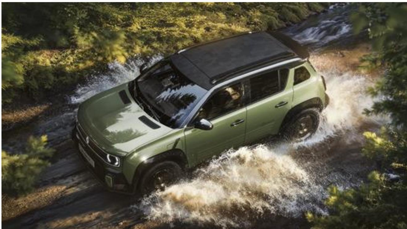
Pour cela, Renault 4 Savane 4x4 Concept bénéficie d'une garde au sol réhaussée de 15 mm par rapport à une version normale de Renault 4 E-Tech electric. Elle reste montée en 18 pouces, mais avec des pneumatiques adaptés Goodyear UltraGrip Performance+ en 225/55 et des jantes spécifiques « Savane », tandis que les voies avant et arrière sont élargies de 10 mm de chaque côté.
