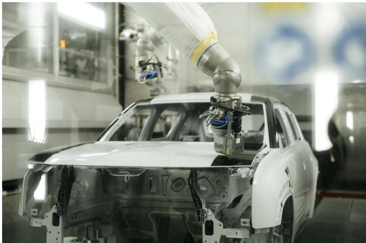
A titre de comparaison, la peinture intégrale de chaque véhicule est réalisée par un jet de 30 à 45 cm de large. La peinture est diffusée en brouillard orientée sur la caisse par de l'air comprimé et de la haute tension en utilisant la technologie dite d'atomisation. « *Le Jetprint Paint est une vraie révolution dans le domaine de la peinture automobile !* » confie Katell.
