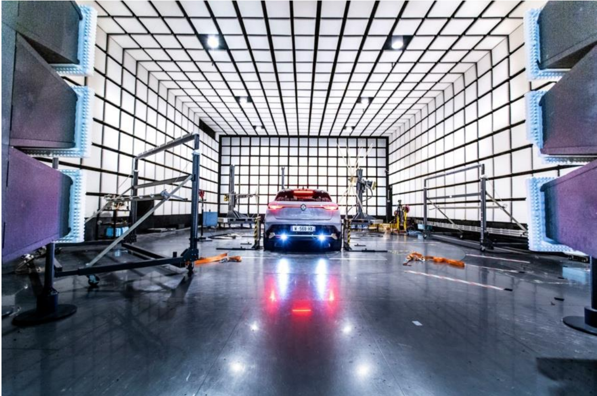
La chambre Immunité, où Mégane E-TECH Electric est soumise à des tests électromagnétiques extrêmes
