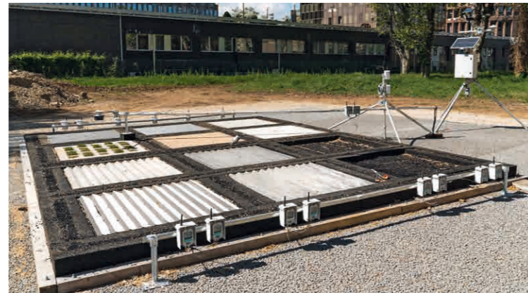
Pour les tests de revêtements du futur chantier de la Part-Dieu, Lyon, Aliapur a fourni une infrastructure isolante faite en gomme de pneus.
