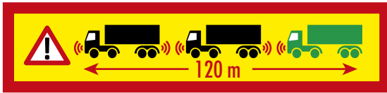
■ Exemple d'affichage sur l'écran électronique arrière du dernier ensemble de véhicules d'un peloton
