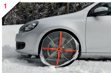
1 Enfilez AutoSock® comme une housse sur le haut du pneumatique (roue motrice).
