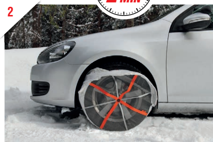
2 Avancez (ou reculez) d'un demi-tour de roue pour finir le montage.
