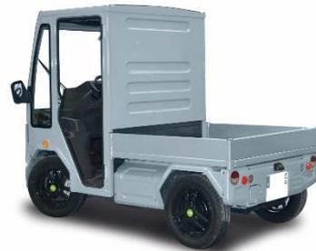
Son petit gabarit (3m<sup>2</sup>) lui permet de circuler dans les rues les plus étroites et de se loger à l'intérieur du BIL LIFT. Capable de transporter des palettes 120 x 120 cm et jusqu'à 600 kg, il facilite les livraisons et en réduit la pénibilité.
