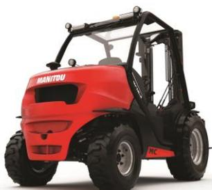
Avec 30 cm, le MC18 détient la plus haute garde au sol du marché des chariots compacts. Cette évolution lui confère une plus grande polyvalence sur tout type de sol, et facilite grandement le franchissement d'obstacles. La hauteur de plancher, accessible sans marche, est conservée grâce à une optimisation des composants moteur de la machine et permet une entrée/sortie cabine sécurisée sans effort.
