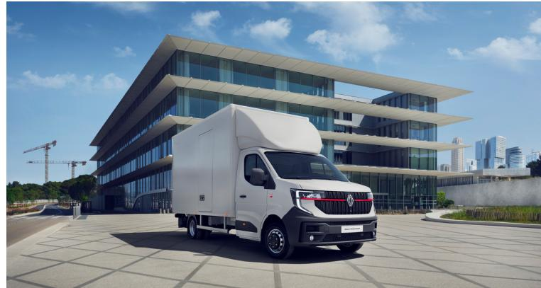
En option, le Renault Trucks Master Red EDITION Propulsion peut recevoir une prise de force moteur (PTO), permettant d'alimenter directement un équipement de carrosserie tel qu'un groupe frigorifique ou un générateur. Un blocage de différentiel arrière améliore la motricité sur terrain glissant (boue, neige) : il synchronise la rotation des roues, facilitant la progression en conditions délicates.
