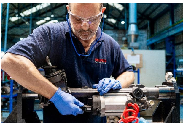
Crémaillère de direction électrique en cours de reconditionnement. Article faisant partie d'une gamme croissante actuellement en pré-production.
