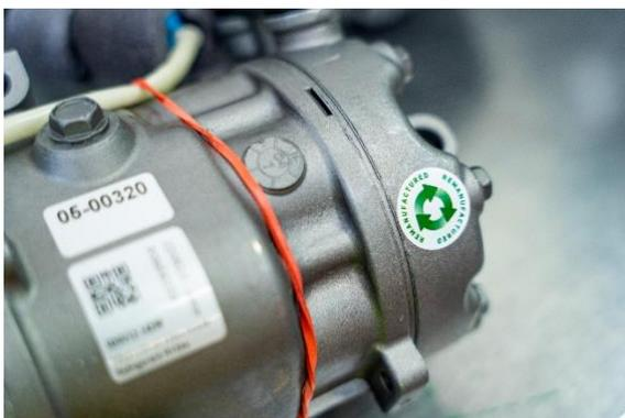
Compresseur de climatisation avec étiquette « reconditionné ».
