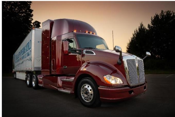
Baptisé "Beta" en interne, ce nouveau prototype étend les performances du démonstrateur initial [Project Portal](#) en portant l'autonomie à plus de 480 km. Il gagne également en polyvalence et en maniabilité en se dotant d'une cabine couchette et d'un compartiment ingénieux de pile à combustible, qui augmente encore l'espace de la cabine sans allonger l'empattement.
