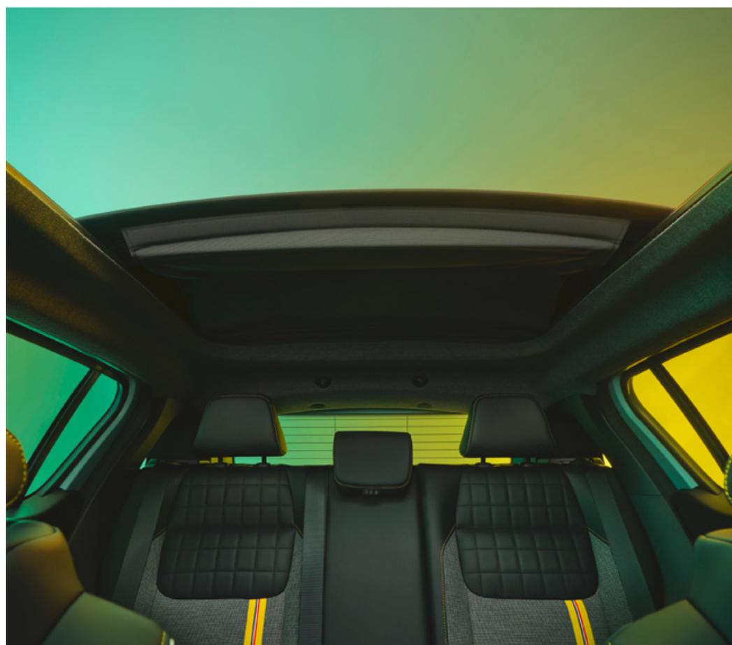
**Sur un véhicule électrique, chaque kilo ayant son importance pour l'autonomie, le choix d'un toit en toile s'est imposé de lui-même. Contrairement à ce qu'on pourrait imaginer, l'acoustique est bien au rendez-vous car le tissu a été travaillé dans ce sens. Et lorsque le toit est ouvert, un déflecteur s'active pour réduire le bruit extérieur lors des phases de roulage.**
