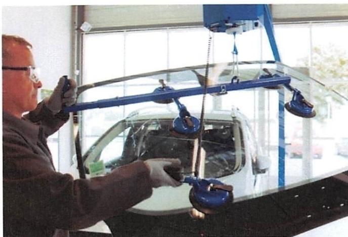
Entièrement démontable, il est peu encombrant et peut être utilisé en intervention à domicile. Entièrement autonome, il fonctionne sur batterie et un chargeur de 220 V vous est fourni. Le FITGLASS COMPLET inclut le moteur, la potence et le cadre avec ventouses. La charge maxi supportée est de 35 kg.
