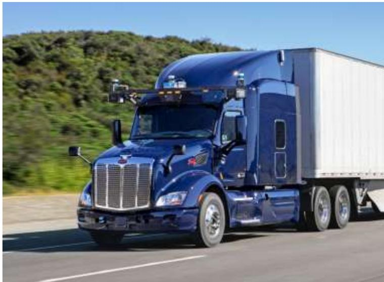
**Véhicule d'essai autonome Peterbilt 579 avec système de conduite Aurora**
