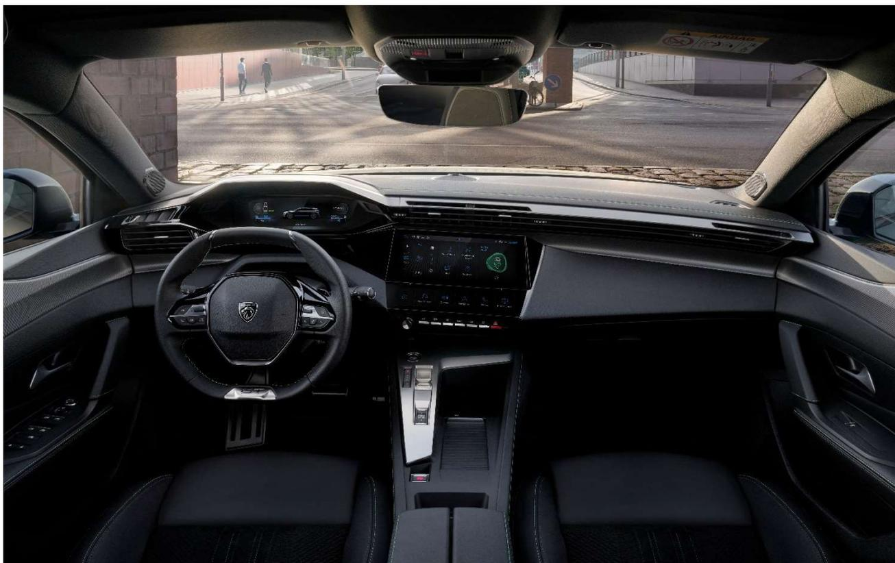
La construction de la planche de bord de la nouvelle PEUGEOT 308 SW repose sur une architecture « high-vent » qui place les aérateurs juste en face de la tête des occupants. Cette position est optimale pour le confort pour le conducteur et les passagers.
