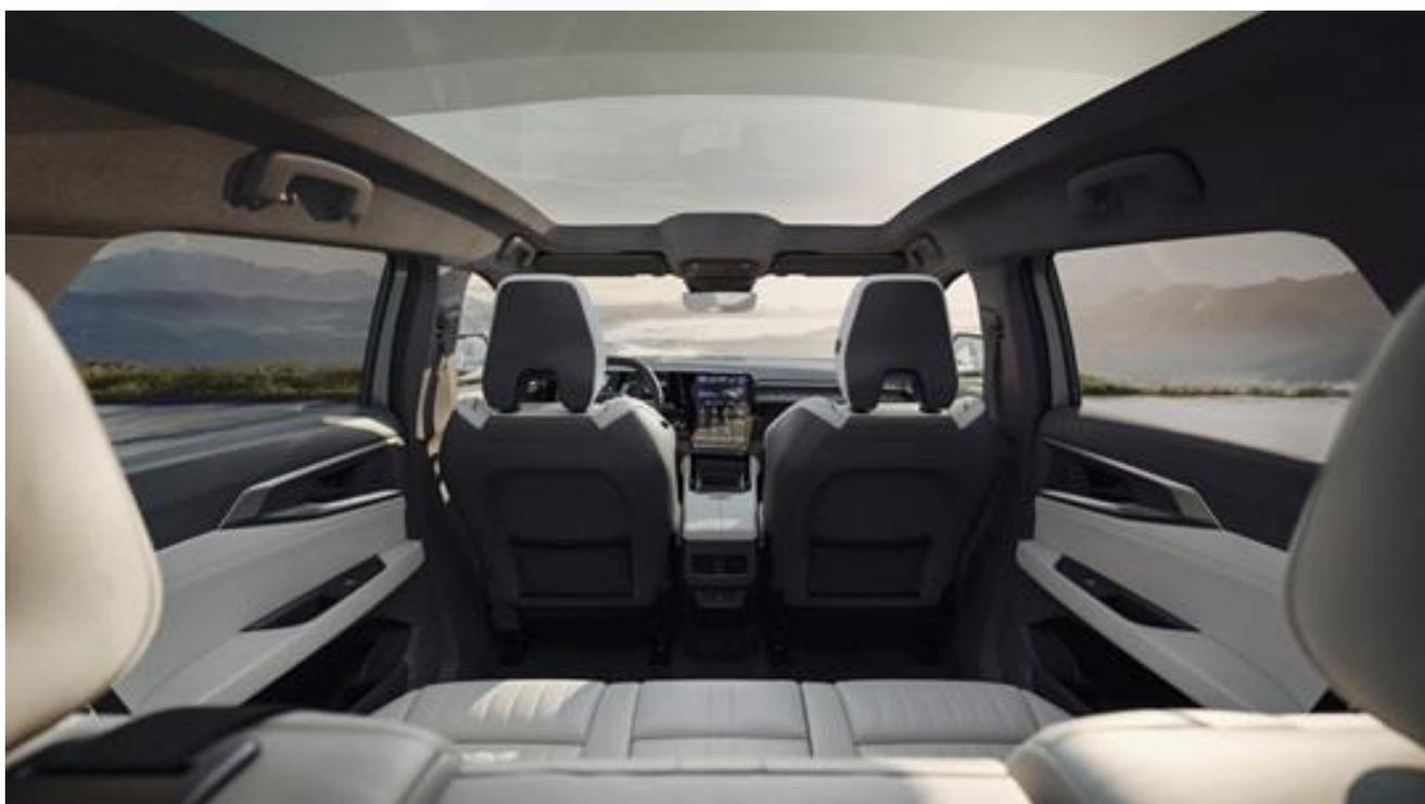
La technologie Solarbay du toit se décompose en neuf segments s'opacifiant à la demande. La protection solaire est maximale et immédiate, sans vélum, permettant de conserver une hauteur confortable sous pavillon pour les occupants de la 2e rangée avec 919 mm.
