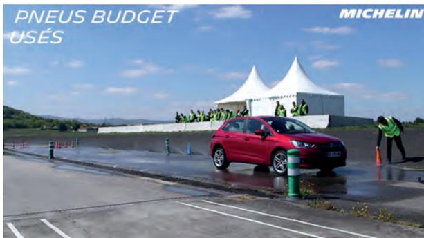
un véhicule plus rapidement que le même pneu neuf. Autre avantage : un pneu usé réduit la consommation de carburant par rapport à un pneu neuf. La résistance au roulement d'un pneu arrivé à la limite d'usure légale représente 80% de celle du même pneu à l'état neuf. Le fait d'attendre la limite légale pour remplacer ses pneus permet donc de les utiliser plus longtemps lorsqu'ils sont les plus efficaces, et de réduire ses frais de carburant.
