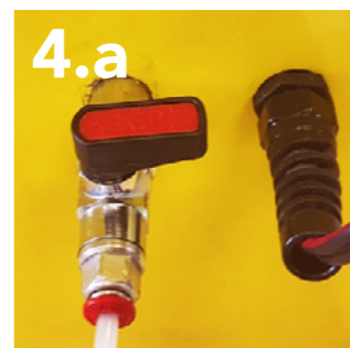
Robinet d'alimentation arrière machine MT424 en position fermée - tirer le robinet pour le mettre en position ouverte.
