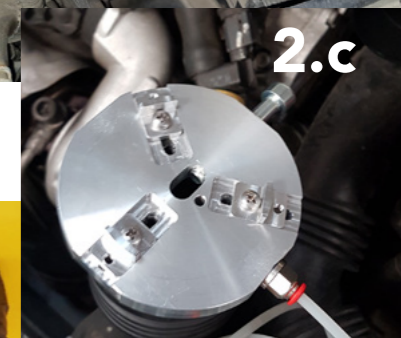
La tête de pulvérisation est en bonne position sur la durite de filtre à air
