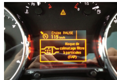
Filtre à particules ou Catalyseur colmaté
