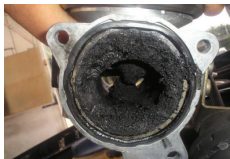
Vanne EGR encrassée
