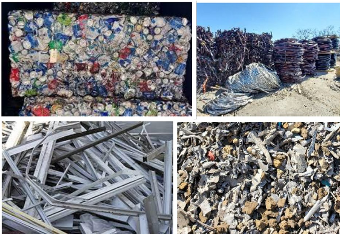
Exemples de déchets en aluminium pouvant être recyclés : cannettes (en haut à gauche) ; câbles électriques (en haut à droite) ; encadrements de fenêtres issus de la démolition bâtiment (en bas à gauche) ; véhicules broyés (en bas à droite).
