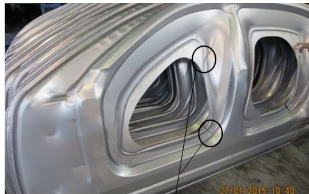
Exemple de défauts pouvant apparaître en emboutissage en cas de ductilité trop faible (pièces de carrosserie).
