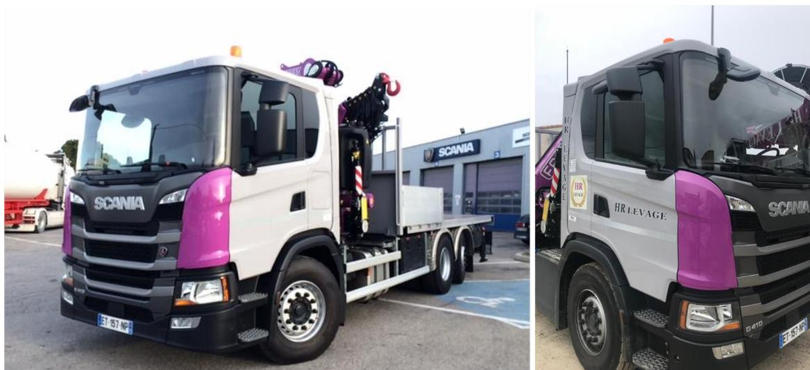
Le porteur Scania de 450 ch 6x2\*4 est équipé d'un essieu avant de 10 tonnes, d'un plateau et d'une grue Fassi de 48t.m qui lui permet de réaliser tous travaux de levage et de manutention, dans des secteurs d'activités aussi variés que l'événementiel, l'art, l'industrie...
