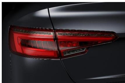
Il faut souligner la technologie et le design innovants de ce feu arrière, qui permet, quel que soit l'angle de vision, de rester parfaitement visible. En effet, c'est grâce à la réflexion de la lumière générée par les LED sur une lentille supplémentaire qu'elle se diffuse de manière étendue et homogène.
