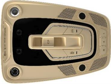
Pour la première fois dans un véhicule de cette gamme, la lumière intérieure peut également être activée, désactivée ou atténuée sans contact, de sorte que l'utilisateur positionne simplement sa main à proximité de la lampe intérieure pour ces fonctions.
