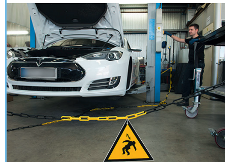
L'intervention sur un véhicule électrifié ou 100% électrique nécessite une ou plusieurs habilitations, dont la première, BCL, concerne la mise en sécurité électrique du véhicule.
