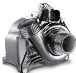
La pompe à eau électrique n'est pas entraînée par courroie mais fonctionne avec le réseau électrique 12 volts embarqué du véhicule.
