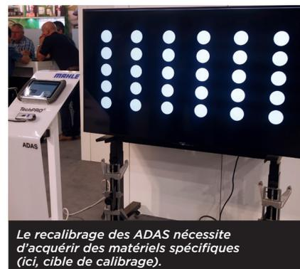
*Le recalibrage des ADAS nécessite d'acquies des matériels spécifiques (ici, cible de calibrage).*
