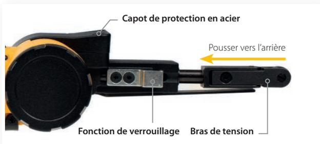
Pour libérer la bande, pousser le bras de tension vers le capot en acier pour le déverrouiller. Pour l'ouvrir, desserrer le bouton du capot de protection.
