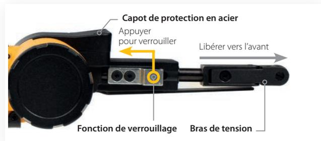
Remplacer par une bande neuve. Refermer le capot de protection et serrer le bouton du capot. Fixer la nouvelle bande en poussant le verrou vers e capot en acier – ce qui libère le bras de tension vers l'avant.
