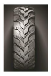
Au-delà de la prouesse qui consiste à sculpter la bande de roulement d'un pneumatique d'un dessin inédit, l'épi de blé matérialisé par le pneumatique MICHELIN LIFEBIB VF 710/70 R42 souscrit aux grandes règles de conception des pneumatiques, ici avec un pain de gomme central et rigide grâce aux grains de blés tressés, ainsi que des effilements latéraux. Précision, guidage, adhérence sont ainsi maintenus...
