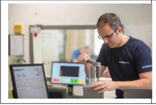
Le banc d'essai mis au point par Federal-Mogul Powertrain permet d'actionner une seule soupape et d'évaluer des séquences individuelles de fermeture.
