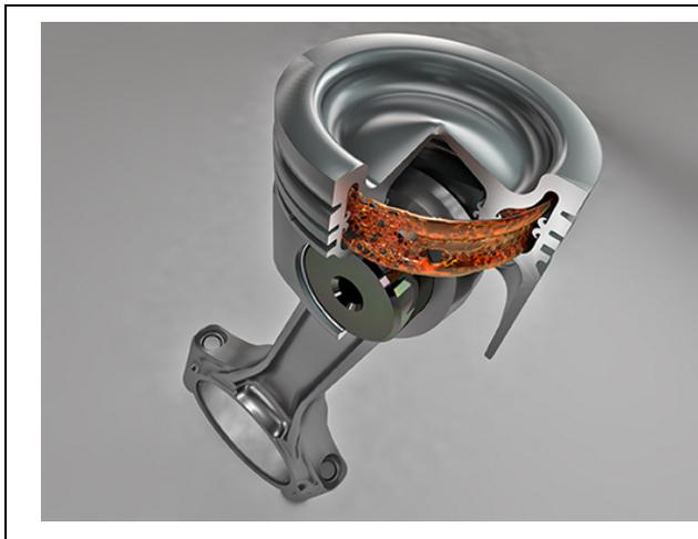
Coupe du piston Monosteel® pour moteur de poids lourd de Federal-Mogul Powertrain montrant la chambre de refroidissement EnviroKool™ scellée à vie à l'intérieur de la couronne.
