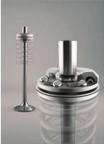
Le Rotocap fait appel à un agencement compact et robuste de billes et de rampes au sein d'un ensemble autonome. La nouvelle version automobile miniaturisée offre une plage de diamètres extérieurs compris entre 20 et 25 mm.
