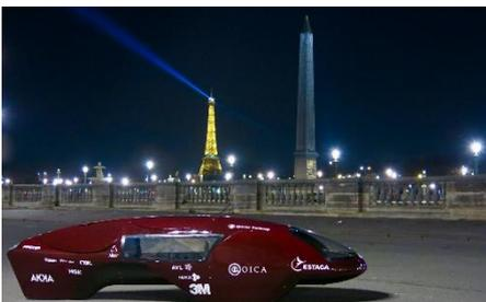
L'équipe travaille par ailleurs à un nouveau projet de reconversion en électrique du véhicule énergétique thermique « Calypso » qui avait effectué un record dans sa catégorie de 1 798 km avec l'équivalent d'1 litre d'essence. Cette monocoque, également en carbone, pèse 30 kg. Ses circuits électriques sont développés sur mesure par l'association, notamment le GMP (groupe moto propulseur), le choix des cellules de batterie et l'interface pilote.
