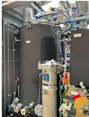
La conception et l'équipement de l'EcoCvario, avec par exemple des cuves d'immersion verticales et optimisées pour l'écoulement, ainsi que les conduites spéciales soudées pour le transport des fluides, sont conçus pour répondre à des exigences élevées en matière de propreté.
