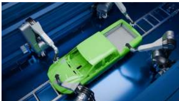
Photo 2 : Le robot de peinture compact EcoRP4 possède une architecture asymétrique.
