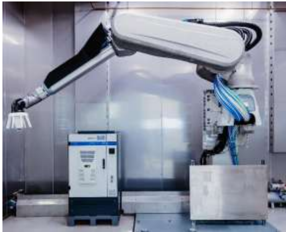
Photo 1 : Le nouveau robot Dürr EcoRP4 séduit par son nombre réduit de composants, son mécanisme simplifié et sa conception facilitant la maintenance.
