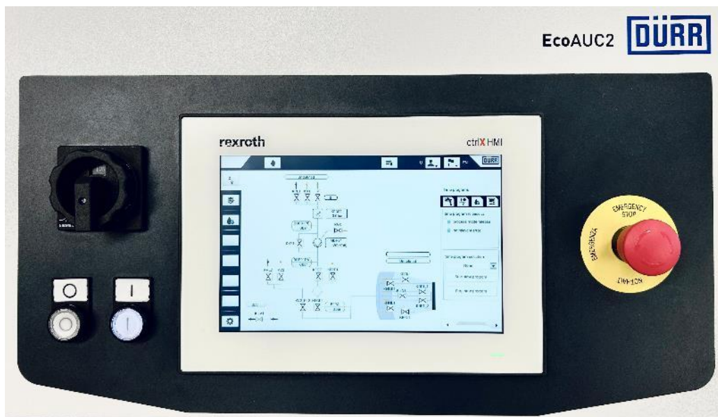
Photo 1 : La visualisation intuitive de l' EcoAUC2 avec grand écran facilite la surveillance des processus et la commande.
