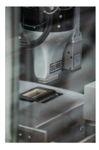
2e photo : Grâce à l'EcoPaintJet Cleaner, tous les processus de nettoyage et de rinçage sont réalisés dans un système fermé.
